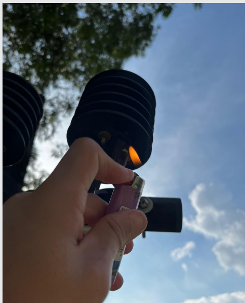
Figura 13. Sensor de temperatura con estímulo para elevar la temperatura ambiental. Fuente: Elaboración propia.
